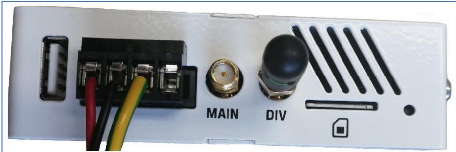
Abb. 8 RAR mit installierter WIFI-Antenne am SMA-Anschluss für den 2,4-GHz Funk.
