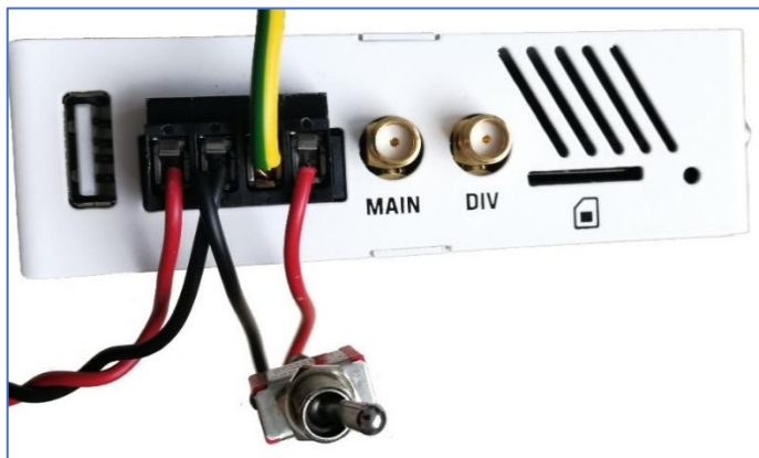
Abb. 3 eingebaute RAR mit installiertem Schalter am digitalen Eingang 1.
