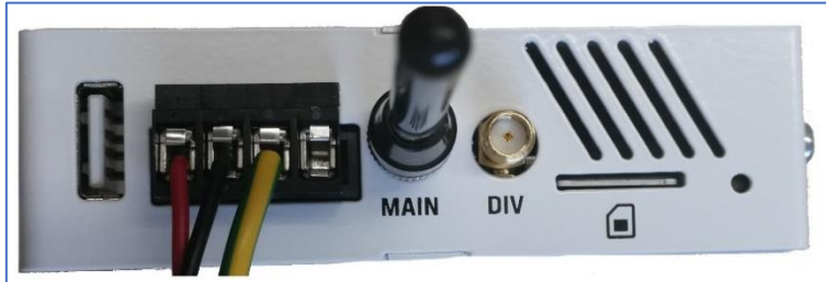
Abb. 7 RAR mit Mobilfunk Option: 3G/4G-Antenne auf dem SMA-Anschluss des Mobilfunkgeräts installiert.
